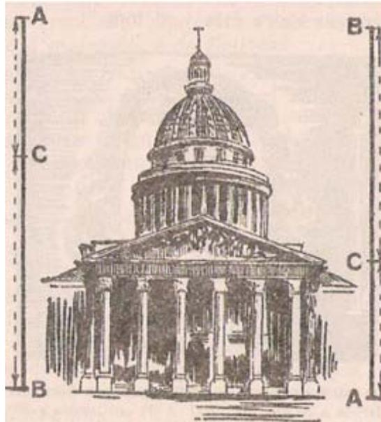
*La división áurea es observada, con admirable nitidez, en las fachadas de los edificios que se distinguen por la perfección de sus líneas arquitectónicas. El famoso "panteón" de París, representado en la figura, es un ejemplo notable. Siendo AB la altura del monumento, el "punto de oro" se destaca de manera inconfundible; es el punto C por el que pasa, ya sea la línea de la base del frontispicio, o el plano que corta la base de la cúpula.*
